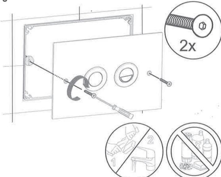
**PT** A superfície das placas cromadas e pintadas não tem a mesma resistência das placas de aço inox. Portanto devem ser limpas unicamente com um pano húmido.
