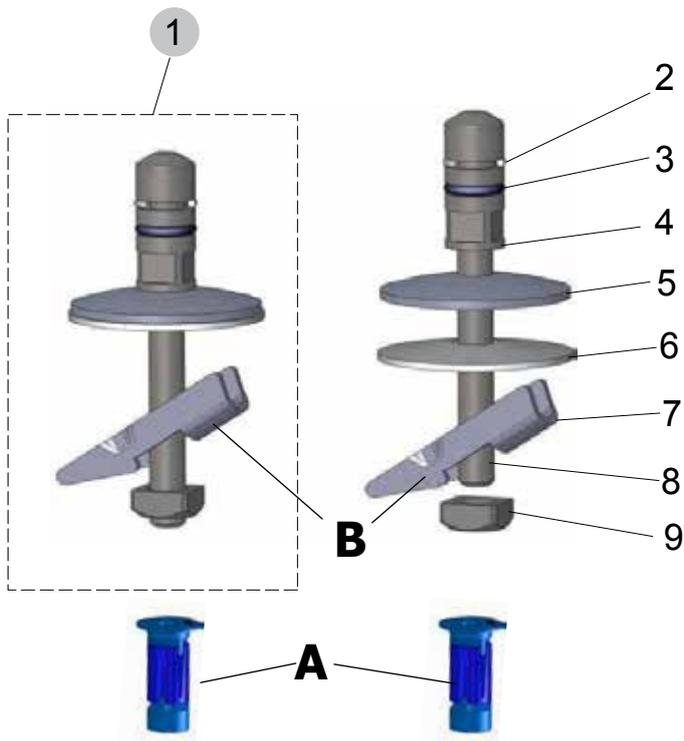
Scharnier-Set mit Befestigung **A** für Keramik mit Sackloch und mit Kippschraub-Befestigung **B** für Durchgangsloch in der Keramik.
