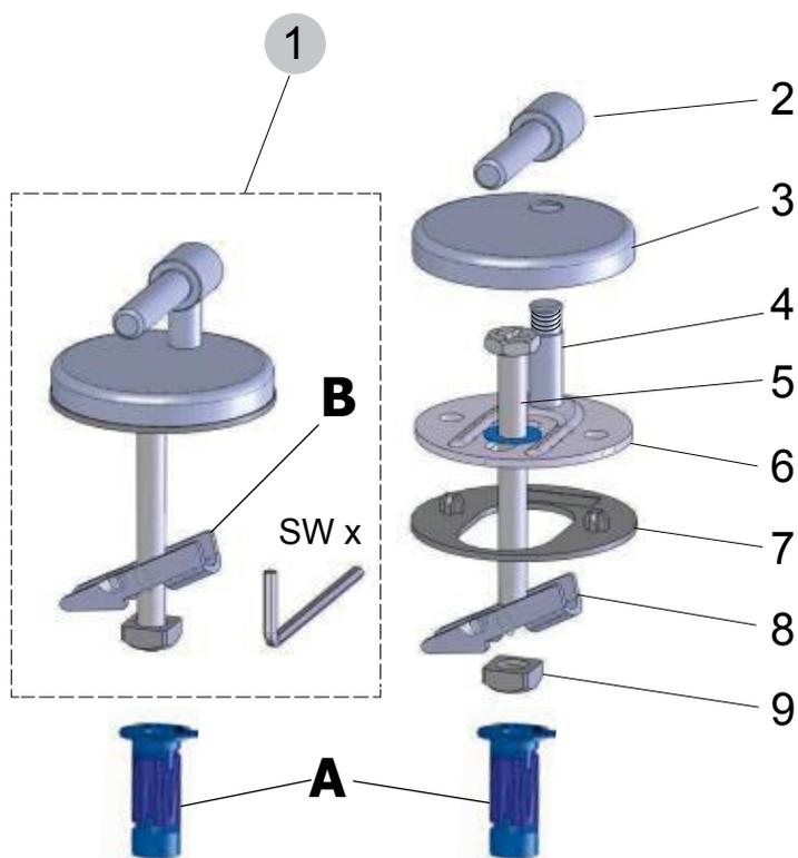
Scharnier-Set mit Befestigung **A** für Keramik mit Sackloch und mit Kippschraub-Befestigung **B** für Durchgangsloch in der Keramik.
